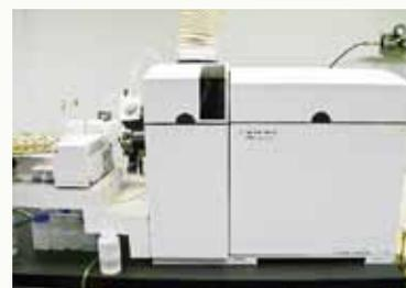
ICP質量分析装置(金属類の分析)
