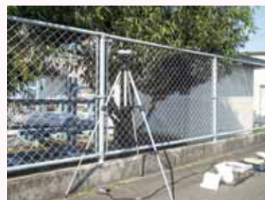
騒音・振動の測定状況
