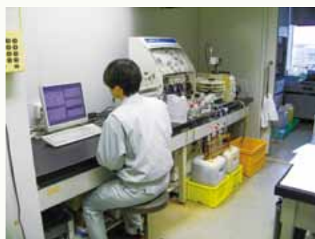
流れ分析法（CFA法）による分析状況
