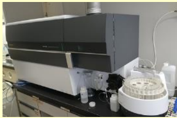
マンガンの分析に用いる ICP 発光分光分析装置
