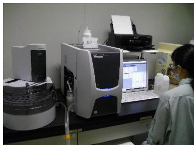
TOC分析装置による 全有機炭素測定の様子
